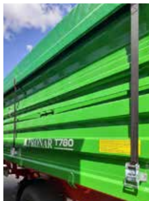
Verlässliche Befestigung der Plane mittels Zurrgurten
