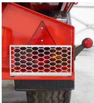
Rücklichter mittels Schutzgitter gesichert
