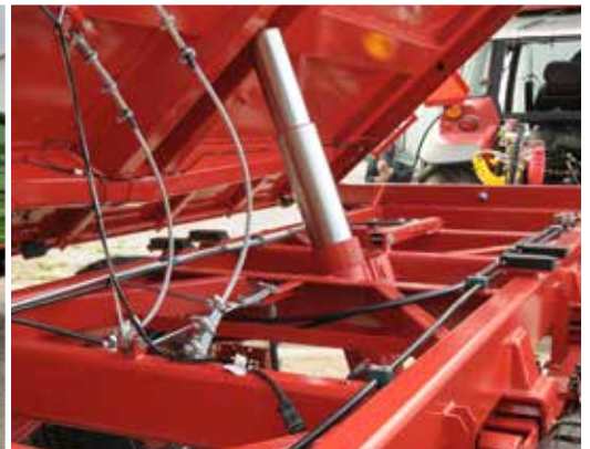
Robustes Fahrgestell durch rechteckige geschlossene Stahlprofile
