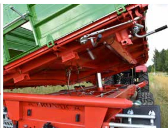
Kippsystem mit gefederten Kugelgelenken (heckseitig)
