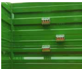
Bordwandstufen erleichtern den Zugang zur und aus der Ladekiste
