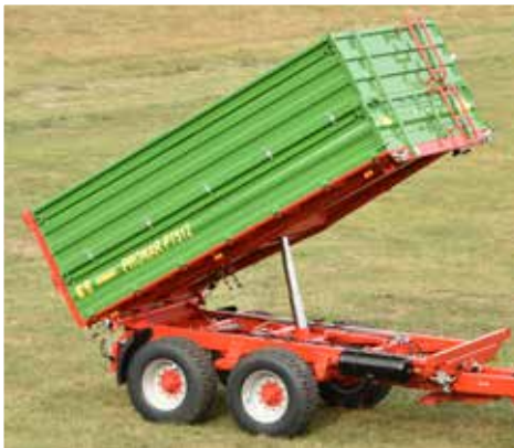
Effektive Entladung dank des zuverlässigen Teleskopzylinders
