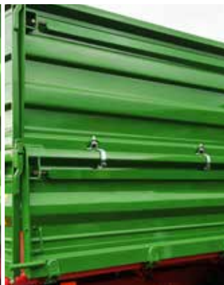
Spannleisten zur Stärkung der Bordwände
