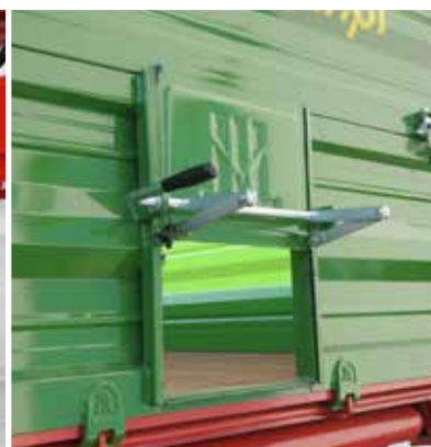
Rückwand mit dichtem Kornschieber
