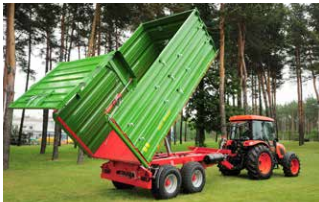
Ladevolumen bei der SILO-Version mit hydraulischer Heckklappe auf 15,7 m 3 erhöht
