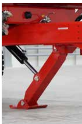
Serienmäßiger hydraulischer Schrägstützfuß
