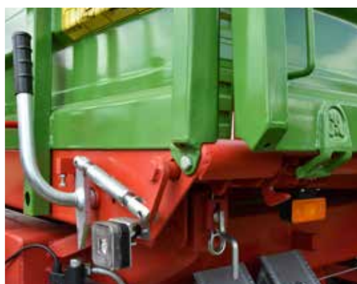
Dreiseitige Verriegelung zur Erleichterung der Bordwandöffnung
