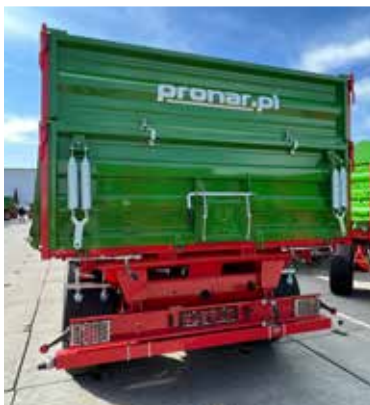
Serienmäßig montierte Bordwandhebefedern ermöglichen eine effiziente Bedienung
