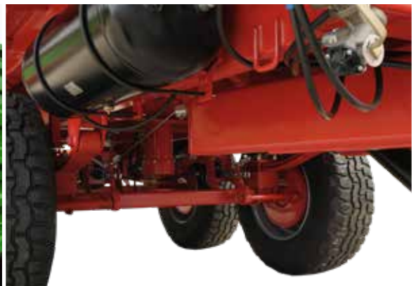
Tandemachsen mit Parabelfederung und entsprechender Spurbreite ermöglichen souveränes Manövrieren auf herausforderndem Gelände
