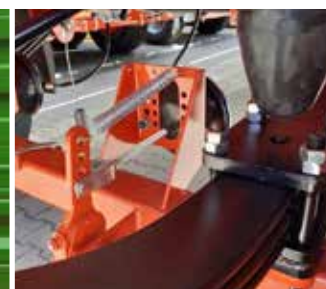
Hoher Fahrkomfort durch Parabelfederung
