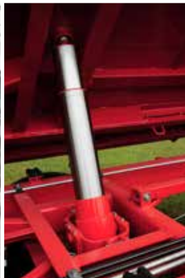
Vierstufiger Teleskopzylinder ermöglicht problemloses Kippen
