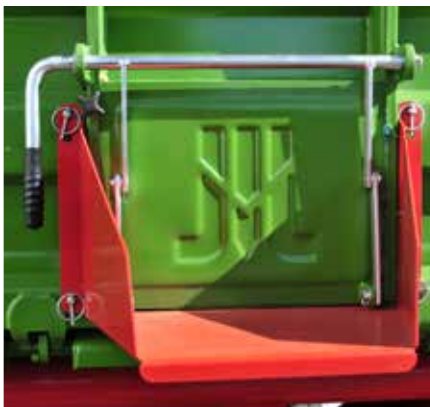
Auslaufgasse ermöglicht gezielte Entladung
