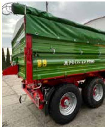
Gesicherter Transport des Ladegutes mittels optionaler Rollplane
