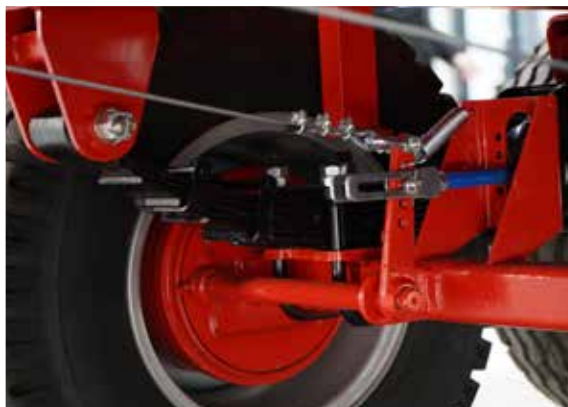
Zuverlässige Blattfederung zur Erhöhung der Belastbarkeit des Kippers auf anspruchsvollem Terrain
