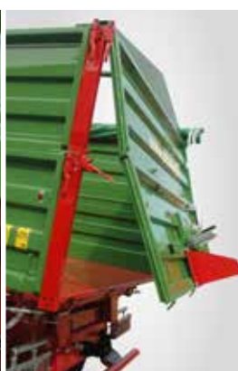
Bordwand und Aufsatz mit Pendelfunktion
