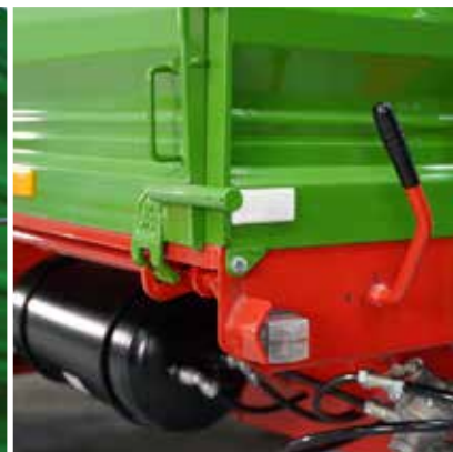
Dreiseitige Verriegelung erleichtert die Bordwandöffnung
