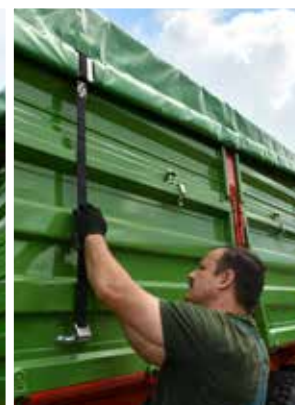
Rollplane mit Spanngurten zur Befestigung
