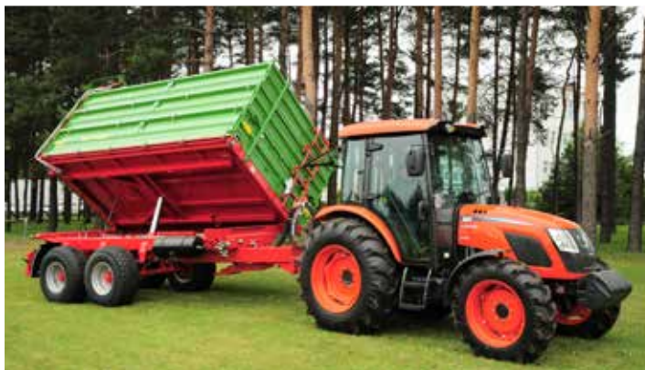
Ladekiste mit universalem Öffnungssystem und konischer Konstruktion (Heckverbreiterung um 50 mm)
