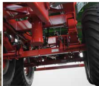
Starkes und solides Fahrwerk mit Parabelfederung erleichtert den Transport auf unwegsamem Gelände.
