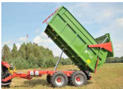
Der aus rechteckigen Stahlprofilen geschweißte Rahmen garantiert eine hohe Belastbarkeit.
