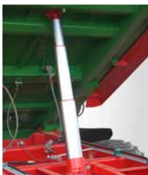
Grosser Kippwinkel der Ladekiste erleichtert die Entladung.
