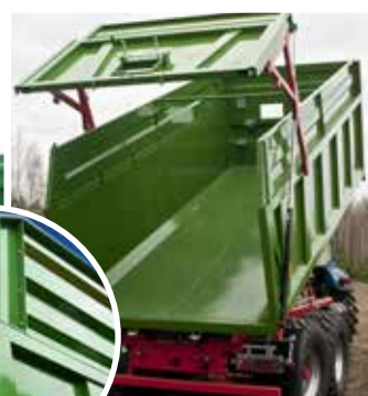
Die hydraulische Steuerung der Heckklappe erhöht die Entladegeschwindigkeit.
