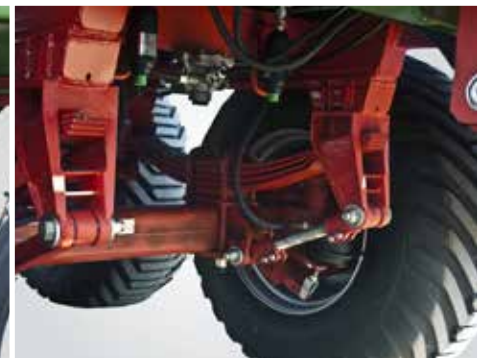
Parabelfederung im Standard. Optional kann auch eine hydraulische Aufhängung gewählt werden.
