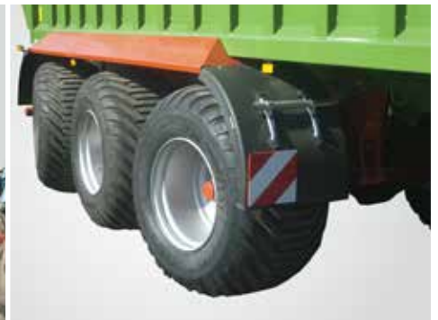
Dank der vorderen und hinteren Lenkachse wird der Reifenverschleiß minimiert.
