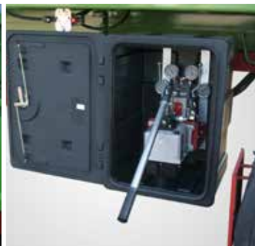
Das Einstellen des Drucks im aktiven Steuersystem nimmt wenig Zeit in Anspruch und ermöglicht flüssiges Manövrieren in den Kurven.
