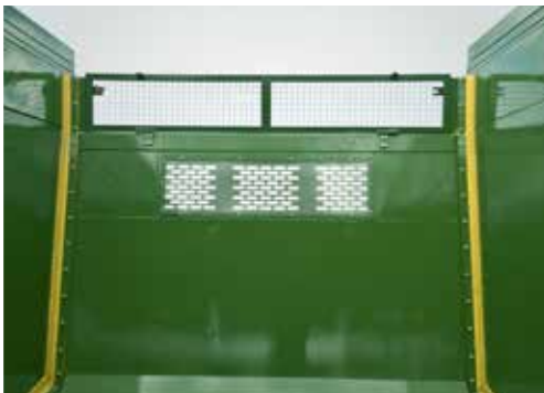
Die Schiebewandfunktion (power push) wurde für die Arbeit mit jeder Art der Ladung vorgesehen.
