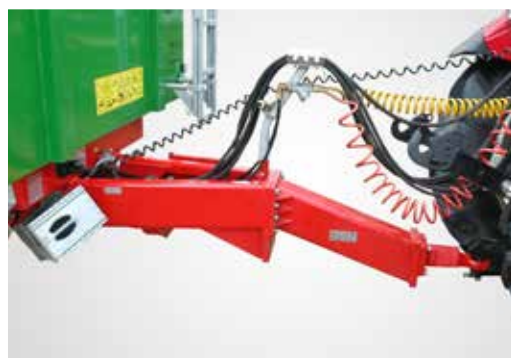
Universal-Deichsel zur Unten- und Obenanhängung.
