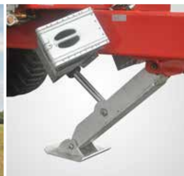
Leicht bedienbarer hydraulischer Schrägstützfuß.
