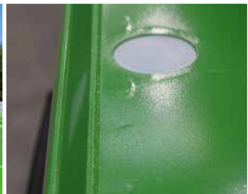
Ladeplattform vorgesehen für die Montage der Rungen
