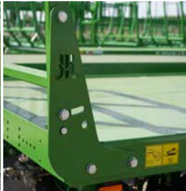
Einstellbarer Neigungswinkel der Ladegitter für den Transport von Rundballen, oder Quaderballen
