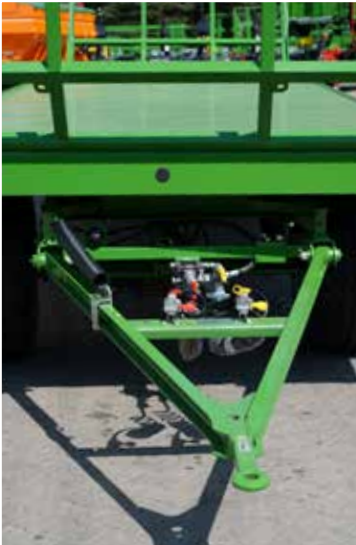
V-Deichsel mit Zugöse Ø40mm
