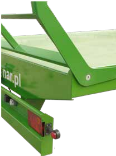
Beleuchtungsanlage mit seitlichen Umrissleuchten
