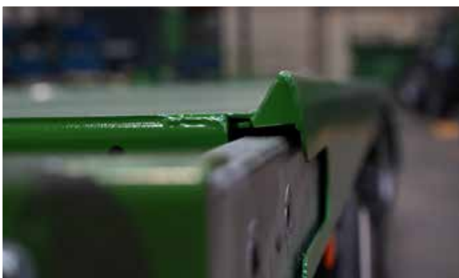
Plattform mit seitlicher Profilaufkantung
