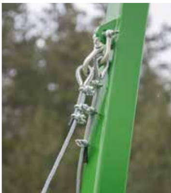
Zusätzliche Ladungssicherung mittels Spannseile für die Ladegitter
