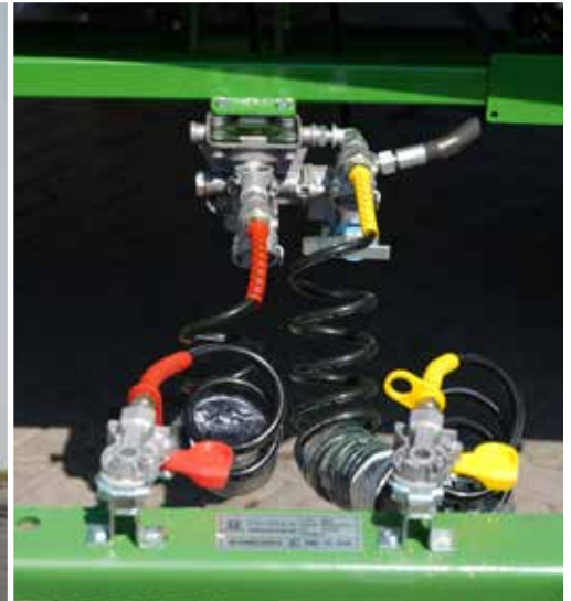
2-Leiter Druckluftbremse: je nach Wunsch manuell, oder automatisch einstellbar
