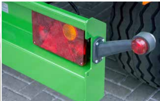
Beleuchtungsanlage mit seitlichen Umrissleuchten
