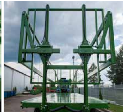
Zeit- und krafteffiziente hydraulische Ladungssicherung (Option)
