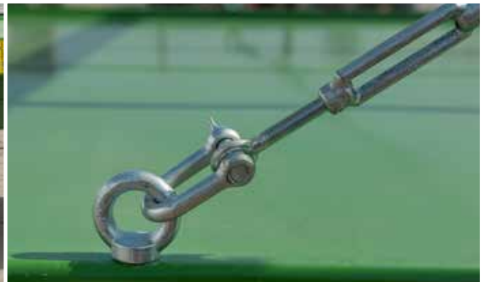
Spannketten als serienmäßige Ausrüstung bei der M – Version des Anhängers, bei der Version ohne M – Spannseile
