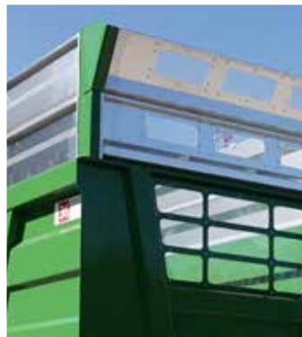
Vorderwand mit Gitterfenster und PLEXI-Scheibe
