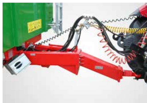
Universal-Deichsel zur Unten- und Obenanhängung.
