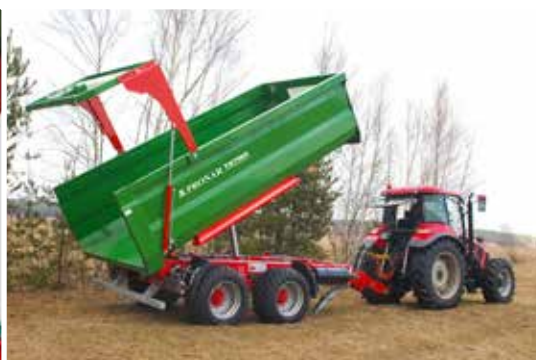
Dank der Gummidichtung in der Heckklappe des T679M kann das Schüttgut sicher und ohne Verlust transportiert werden.
