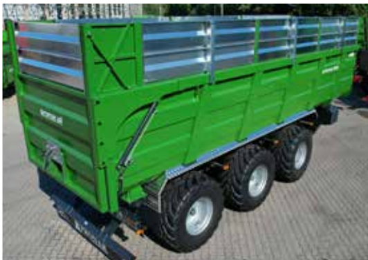
Aluminium-Aufsätze eingesteckt in Stahlpfosten, befestigt mit Stahltraversen – Ladevolumen bis zum 45 m³
