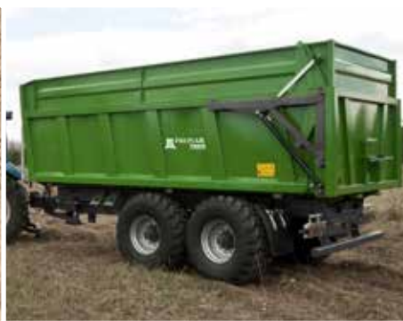
Trapezförmige Ladekiste und ihr Ladevolumen bieten sehr große Transportmöglichkeiten.
