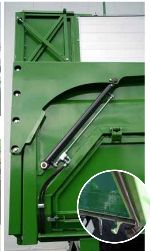
Hydraulische Heckklappe mit Gummidichtung und automatischer Verriegelung
