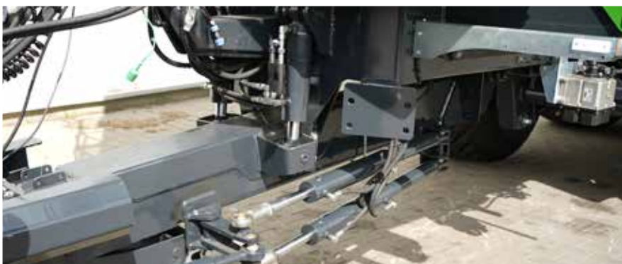
Hydraulisch gefederte Deichsel mit Höhenverstellung
