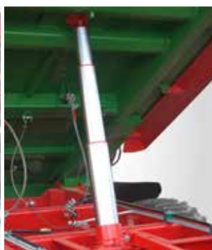
Grosser Kippwinkel der Ladekiste erleichtert die Entladung.
