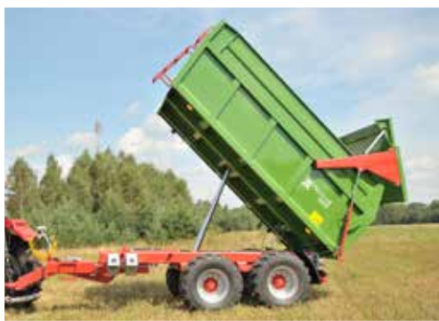
Der aus rechteckigen Stahlprofilen geschweißte Rahmen garantiert eine hohe Belastbarkeit.
